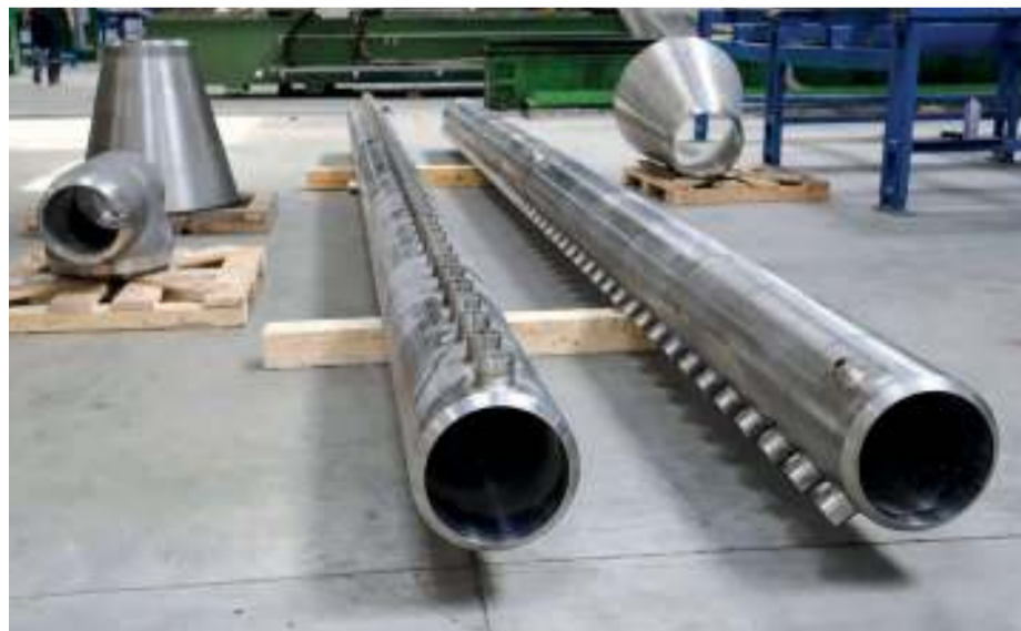
Новую продукцию изготавливают методом статического жаропрочного литья
